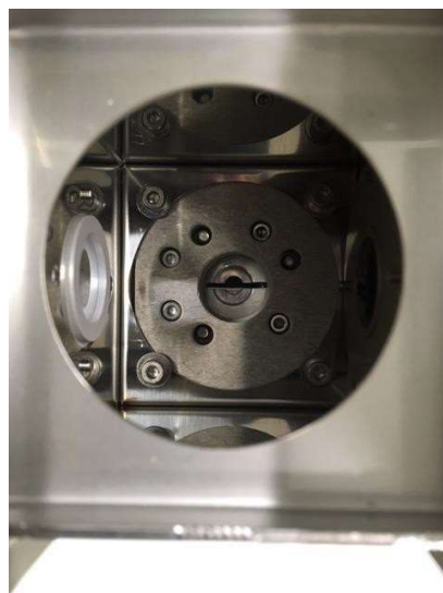
從正上方看下去的圖片 中央的地方為陰極金屬部的插入口。
